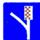
6.5 Полоса аварийной остановки
